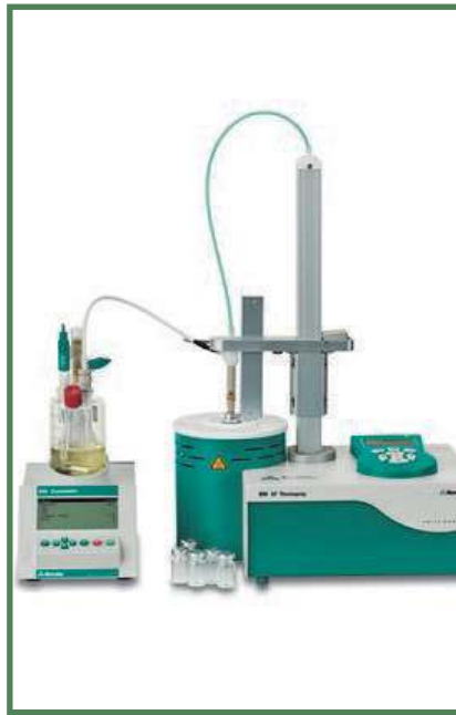
Análisis para la determinación humedad líquido dieléctrico
