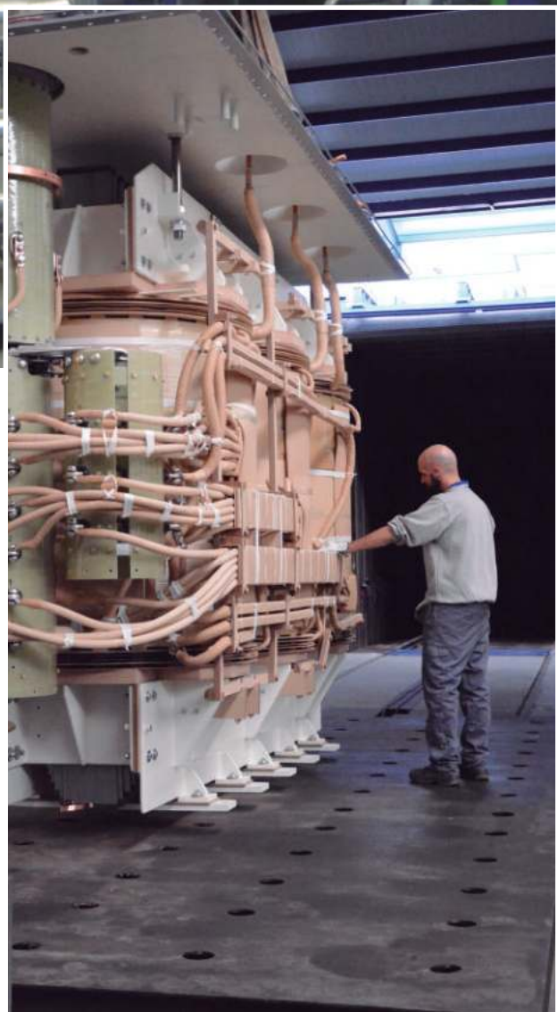
Tratamiento en Vapour Phase
