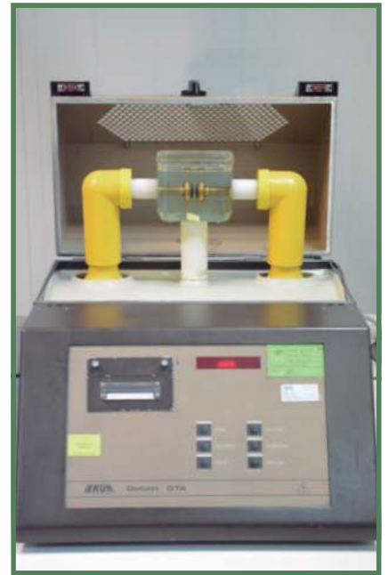
Análisis para la determinación rigidez dieléctrica líquido dieléctrico
