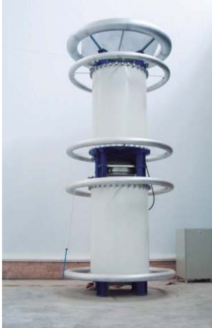
Sistema de tensión aplicada
