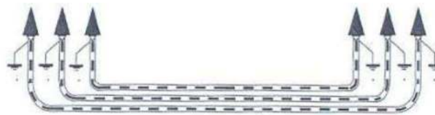
Figura 34. Puesta a tierra de Cubiertas Metálicas
