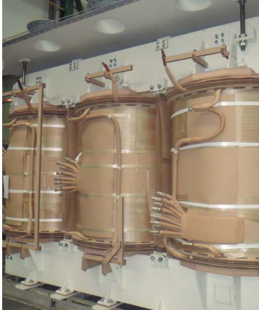
Parte activa del transformador
